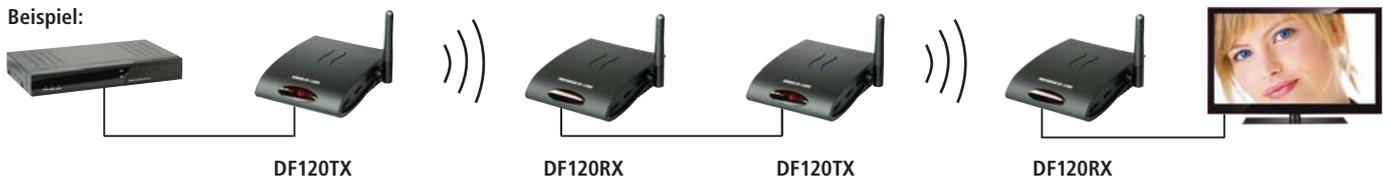
Die Funkstrecke kann durch einen Repeater verlängert werden, hierzu einfach ein weiteres Set in die Mitte der Funkstrecke setzen und dessen Empfänger und Sender miteinander verkabeln (Adapter erforderlich, z.B. CKUCKU). Den minimalen Abstand
